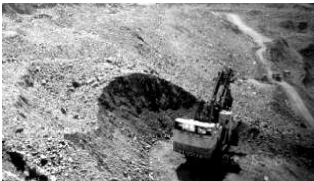
Рис. 14 Виймання екскаватором ЕКГ-8 І породи подрібненої ЕВР україніт-ПМ
