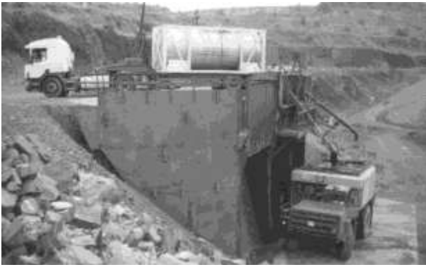
Рис. 10 Злив емулькому із доставочної машини в змішувально-зарядну машину
